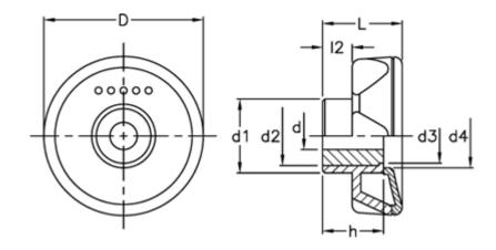
$$\begin{array}{lll} D & = 56 & | 12 = 11 \\ d1 & = 26.5 \\ d2 & = 22 \\ d3 & = 20.5 \\ d4 & = 23 \end{array}$$
